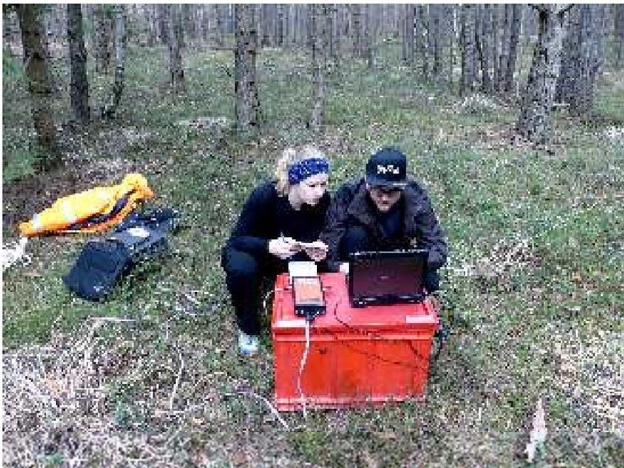
**Abb. 3: Studenten der Montanuniversität Leoben bei geoelektrischen Messungen (Foto: B. Cech).**
